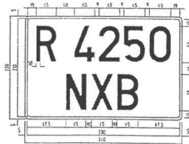
Matrícula remolques y semirremolques alta
